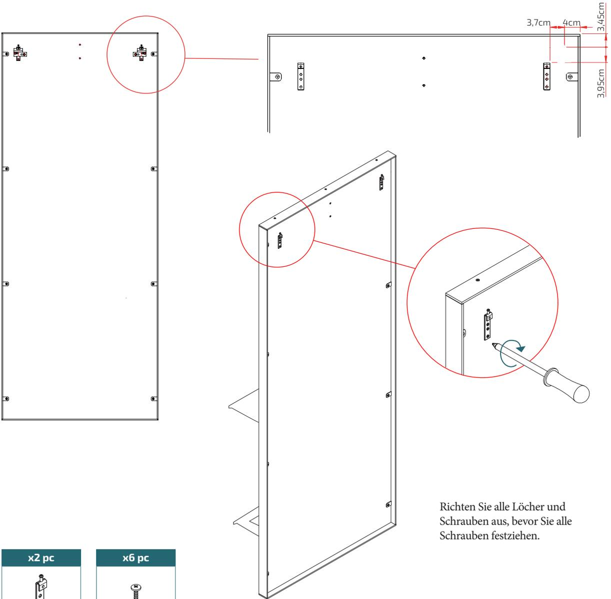
Richten Sie alle Löcher und Schrauben aus, bevor Sie alle Schrauben festziehen.
