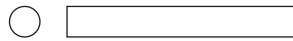
RR. \Phi 4 \times 30 mm Metal Pin x 2 chevilles de metal \Phi 4 \times 30 mm x 2 \Phi 4 \times 30 mm Clavija metálica x 2
