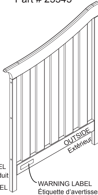
J. Right Crib End x 1 Extrémité droite du lit de bébé Part # 23551
