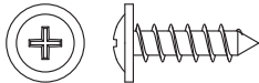
EE. 15mm Back Panel Screw x18 Vis Pour Panneau Arrière Tornillo de Panel Trasero
