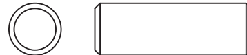
S \Phi 10x30 mm Wood Dowel x 2 Pasador de madera \Phi 10x30mm x 2 5329
