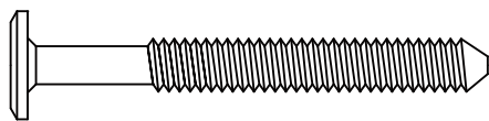
C. M6 x 55 mm Bolt x 2 Boulon M6x55 mm x 2 Perno M6x55mm x 2 5468
