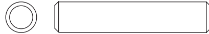
V. \Phi 8 \times 40 mm Wood Dowel x 4 Cheville en bois \Phi 8 \times 40 mm x 4 Pasador de madera \Phi 8 \times 40 mm x 4
