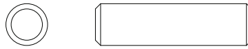
KK. \Phi 8x30 mm Dowel x 4 Cheville \Phi 8x30 mm Pasador \Phi 8x30 mm
