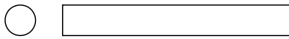
E. \Phi 4 \times 30 mm Metal Pin x 2 chevilles de metal \Phi 4 \times 30 mm x 2 \Phi 4 \times 30 mm Clavija metálica x 2
