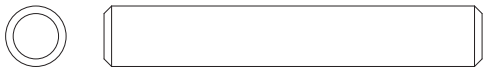
JJ. Φ8 x 50mm Wood Dowel x12 Cheville en bois M8 x 50mm Pasador de madera M8 x 50mm
