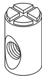
T. M6 x17 mm Barrel Nut x 2 Écrous À Portée Cylindrique M6 x 17mm 5479
