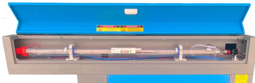
Vous devez coller un morceau de ruban adhésif sur chaque étape du chemin du laser pour marquer et confirmer que cette étape reste correctement alignée. Si ce n'est pas le cas, utilisez les supports du tube laser ou les vis à l'arrière du miroir mal aligné pour résoudre le problème. Dès que le ruban adhésif mis à disposition est épuisé, nous recommandons le ruban de masquage, car il est facile à manipuler et à utiliser.
