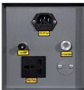
La variation de la tension du réseau doit être inférieure à 5 %. En cas de dépassement, les fusibles peuvent sauter. Ils se trouvent dans la prise de raccordement et sont accessibles de l'extérieur. Ne branchez pas non plus l'appareil sur des rallonges standard ou des multiprises. Branchez-le directement sur une prise de courant reliée à la terre ou utilisez une protection contre les surtensions d'une puissance nominale supérieure à 2000 J.
