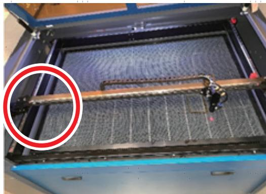
Une fois réglé, placez un autre morceau de ruban adhésif sur le cadre du 2e miroir. Ne posez **PAS** le ruban adhésif directement sur le miroir. Répétez les étapes du chapitre 5.4.1 et réglez si nécessaire les vis de réglage du 1er miroir. Répétez le test jusqu'à ce que le faisceau soit bien aligné et resserrez les écrous des vis de réglage.
