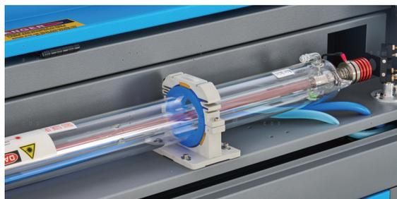
Vous devez coller un morceau de ruban adhésif sur chaque étape du chemin du laser pour marquer et confirmer que cette étape reste correctement alignée. Si ce n'est pas le cas, utilisez les supports du tube laser ou les vis à l'arrière du miroir mal aligné pour résoudre le problème. Dès que le ruban adhésif mis à disposition est épuisé, nous recommandons le ruban de masquage, car il est facile à manipuler et à utiliser.
