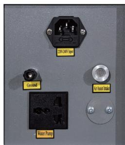
La variation de la tension du réseau doit être inférieure à 5 %. En cas de dépassement, les fusibles peuvent sauter. Ils se trouvent dans la prise de raccordement et sont accessibles de l'extérieur. Ne branchez pas non plus l'appareil sur des rallonges standard ou des multiprises. Branchez-le directement sur une prise de courant reliée à la terre ou utilisez une protection contre les surtensions d'une puissance nominale supérieure à 2000 J.
