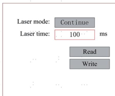
Le fonctionnement est le même que pour le réglage précédent. Lorsque "Continue" est sélectionné, appuyez sur **PULSE** pour tirer le laser et relâchez le bouton pour arrêter le tir. Pour terminer le réglage, sélectionnez **Write** avec la **touche ENT** pour l'enregistrer ou quittez le menu avec la touche **ESC** sans appliquer vos modifications. Les paramètres enregistrés peuvent être chargés via **Read**.
