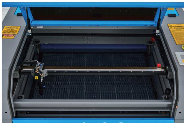
Une fois réglé, placez un autre morceau de ruban adhésif sur le cadre du 2e miroir. Ne posez **PAS** le ruban adhésif directement sur le miroir. Répétez les étapes du chapitre 5.4.1 et réglez si nécessaire les vis de réglage du 1er miroir. Répétez le test jusqu'à ce que le faisceau soit bien aligné et resserrez les écrous des vis de réglage.
