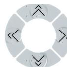
Déplace la tête laser le long des axes X et Y ou déplace le curseur lors de la sélection des paramètres.
