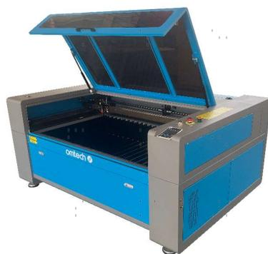
La fluctuation le long de la ligne doit être inférieure à 5 %. En cas de dépassement, les fusibles sautent. Ils sont situés dans la prise de raccordement et sont accessibles de l'extérieur. De même, ne branchez pas cet appareil sur des rallonges ou des multiprises standard. Branchez-le directement sur une prise de terre ou utilisez un parasurtenseur d'une capacité supérieure à 2000J.
