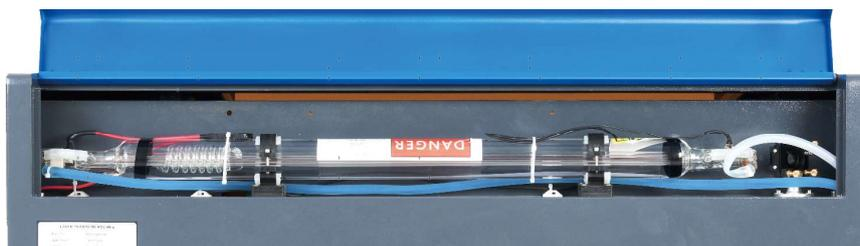
Vous devez coller un morceau de ruban adhésif sur chaque étape du chemin du laser pour marquer et confirmer que cette étape reste correctement alignée. Si ce n'est pas le cas, utilisez les supports du tube laser ou les vis à l'arrière du miroir mal aligné pour résoudre le problème. Dès que le ruban adhésif mis à disposition est épuisé, nous recommandons le ruban de masquage, car il est facile à manipuler et à utiliser.
