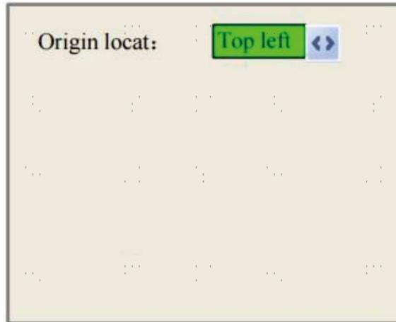
Cette interface définit la position relative de l'origine. Différentes positions de l'origine peuvent générer différentes réflexions du graphique sur l'axe X/Y. La méthode d'opération est la même que celle décrite ci-dessus.
