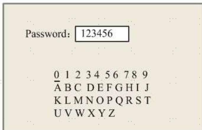
Appuyez sur ◀ ou ▶ et ▲ ou ▼ pour sélectionner un mot de passe et appuyez sur Enter pour l'enregistrer. Les paramètres actuels de la machine seront stockés par défaut. Ils peuvent ensuite être récupérés en utilisant la commande Restore Default Parameters (Restaurer les paramètres par défaut). Il est recommandé de sauvegarder les paramètres d'usine par défaut de votre machine, afin de pouvoir les restaurer facilement en cas de besoin.
