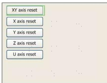
Appuyer sur ▲ ou ▼ pour sélectionner un élément. Appuyez sur Enter pour lancer la réinitialisation de l'axe sélectionné, et le message "Resetting Is Underway" (réinitialisation en cours) s'affiche à l'écran. Une fois la réinitialisation terminée, le message disparaît automatiquement et le système revient à l'interface principale.
