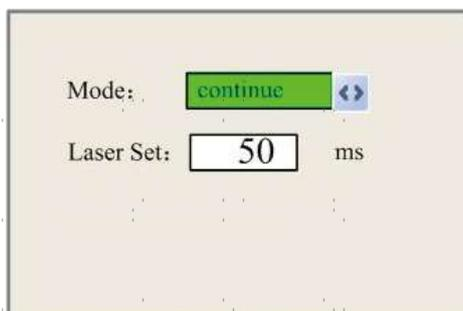
La méthode de fonctionnement est la même que pour le réglage précédent. Lorsque Continu est sélectionné, appuyez sur Pulse pour déclencher le laser et relâchez la touche pour terminer le tir. Lorsque Manuel est sélectionné, appuyez sur Pulse pour déclencher le laser pendant la durée exacte indiquée à côté de Laser Set dans cet écran.
