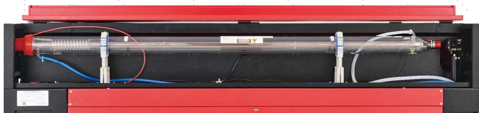
Vous devez coller un morceau de ruban adhésif sur chaque étape du chemin du laser pour marquer et confirmer que cette étape reste correctement alignée. Si ce n'est pas le cas, utilisez les supports du tube laser ou les vis à l'arrière du miroir mal aligné pour résoudre le problème. Dès que le ruban adhésif mis à disposition est épuisé, nous recommandons le ruban de masquage, car il est facile à manipuler et à utiliser.
