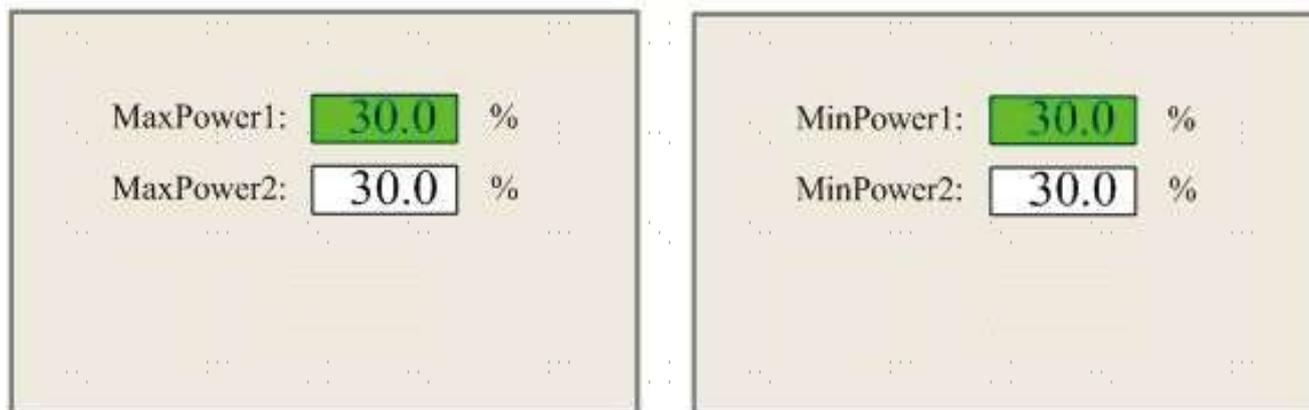
Lorsque l'on appuie sur **Z/U**, le bloc vert peut se déplacer vers le haut et vers le bas pour indiquer l'élément à modifier. Les touches **▲** ou **▼** et **◀** ou **▶** permettent alors de modifier la valeur. Appuyez sur **ENTER** pour enregistrer la modification. Appuyez sur **ESC** pour invalider la modification et revenir à l'interface principale.
