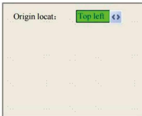
Cette interface définit la position relative de l'origine. Des positions d'origine différentes peuvent générer des reflections différentes du graphique sur l'axe X/Y. La méthode d'opération est la même que celle décrite ci-dessus.
