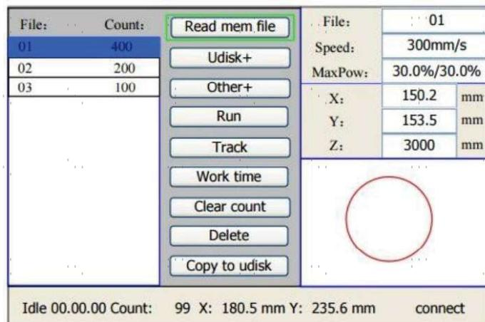
Le système lit automatiquement les fichiers de la mémoire. Le nom du fichier et les temps de travail seront listés et le file sélectionné sera prévisualisé dans le coin supérieur droit. Different memory files can be selected by using ▲ or ▼. Appuyez sur **ENTER** pour prévisualiser le file sélectionné sur l'interface principale. Appuyez sur **ESC** pour fermer l'aperçu.
