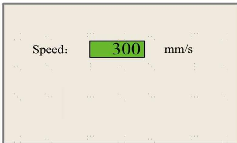
Un curseur apparaît en appuyant sur **◀** ou **▶**. Déplacer le curseur dans la zone numérique et appuyer sur **▲** ou **▼** pour modifier la valeur. Appuyez sur **ENTER** pour enregistrer la modification. Appuyez sur **ESC** pour annuler la modification et revenir à l'interface principale.
