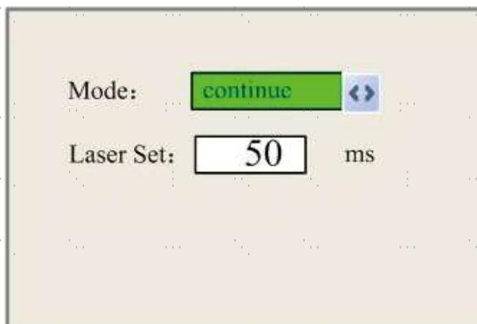
La méthode de fonctionnement est la même que pour le réglage précédent. Lorsque Continu est sélectionné, appuyez sur PULSE pour fire le laser, et relâchez la touche pour finir le firing. Lorsque l'option Manuel (Manuel) est sélectionnée, une pression sur PULSE déclenche la fire du laser pendant la période indiquée à côté de Laser Set (Réglage du laser) dans cet écran.
