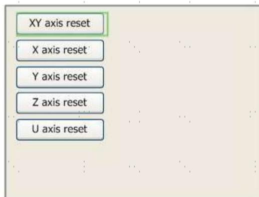
Appuyez sur ▲ ou ▼ pour sélectionner un élément. Appuyez sur **ENTER** pour démarrer la réinitialisation de l'axe sélectionné, et le message "Resetting Is Underway" s'affichera à l'écran. Une fois la réinitialisation terminée, le message disparaît automatiquement et le système revient à l'interface principale.
