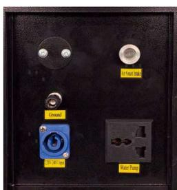
**Branchement :** Alignez la partie surélevée de la fiche avec la prise, insérez-la et tournez-la dans le sens des aiguilles d'une montre jusqu'à ce qu'elle soit bien verrouillée.
