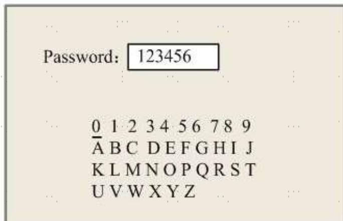
Appuyer sur ◀ ou ▶ et ▲ ou ▼ pour sélectionner un mot de passe et appuyer sur **ENTER** pour l'enregistrer. Les paramètres actuels de la machine seront stockés par défaut. Ils peuvent ensuite être récupérés en utilisant la commande Restore Default Parameters (Restaurer les paramètres par défaut). Il est recommandé de sauvegarder les paramètres d'usine par défaut de votre machine, afin de pouvoir les restaurer facilement en cas de besoin.
