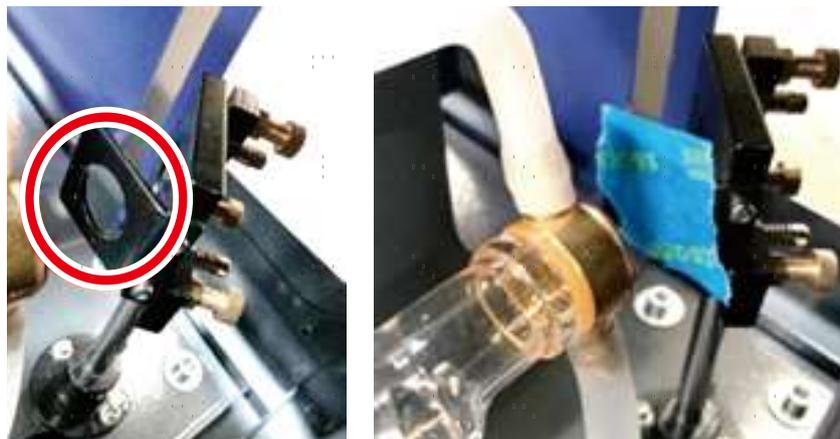
**NE PAS** placer le ruban adhésif directement sur le miroir. Allumez la machine et réglez la puissance à 15 % ou moins.
