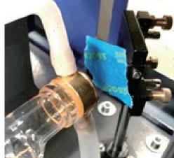
NE PAS placer le ruban adhésif directement sur le miroir. Allumez la machine et réglez la puissance à 15 % ou moins
