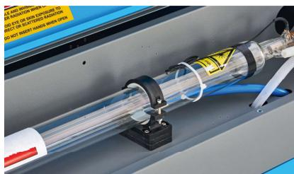
Vous devrez placer un morceau de ruban adhésif à chaque étape de la trajectoire du laser, en le marquant pour confirmer que cette étape reste correctement alignée. Si ce n'est pas le cas, vous utiliserez les supports du tube laser ou les vis à l'arrière du miroir mal aligné pour corriger le problème. Lorsque le ruban adhésif fourni est épuisé, nous vous recommandons d'utiliser du ruban adhésif de masquage, qui est facile à manipuler et à utiliser.
