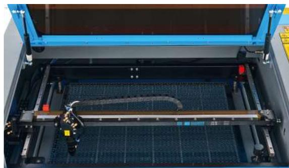
Une fois la fixation effectuée, placez un autre morceau de ruban adhésif sur le cadre du deuxième miroir. **NE PAS** placer le ruban directement sur le miroir. Répétez les étapes du §5.4.1 et, si nécessaire, ajustez les vis de réglage sur le 1er miroir. Testez à nouveau jusqu'à ce que le faisceau soit bien aligné et resserrez les écrous sur les vis de réglage.
