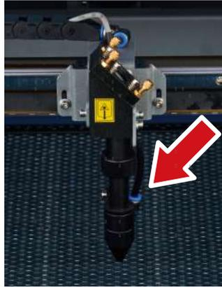
5. Une fois la lentille placée sur le tissu de nettoyage propre, retirez-la de son support en tournant délicatement ce dernier et en laissant tomber la lentille et son joint torique sur le tissu de nettoyage.
