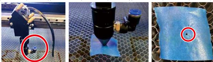
Lorsque le laser est bien centré sur l'ensemble du trajet entre le tube et la table de travail, vos miroirs laser sont tous correctement calibrés et (s'ils sont propres) fonctionnent avec une efficacité optimale.
