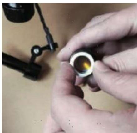
4. Retirez le tuyau d'air comprimé et les raccords du guide laser.
