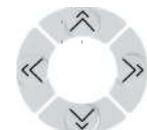
Déplace la tête laser le long des axes X et Y ou déplace le curseur lors de la sélection des paramètres.
