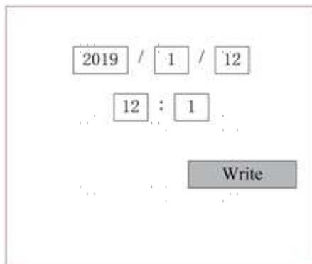
Actionnez les flèches pour sélectionner et régler les paramètres. Pour terminer le réglage, déplacez le curseur sur Write et appuyez sur ENT pour enregistrer vos modifications ou quittez le menu avec la touche ESC sans les appliquer. Read permet de charger les paramètres enregistrés.
