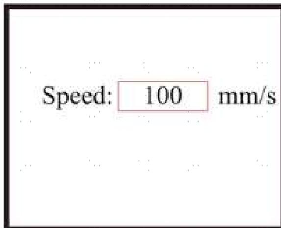
Pour modifier la valeur du paramètre, appuyez sur les touches ▲ et ▼. Appuyez sur **ENT** pour valider la modification, enregistrer la modification. Appuyez sur la **touche ESC** pour invalider la modification et revenir au menu principal.
