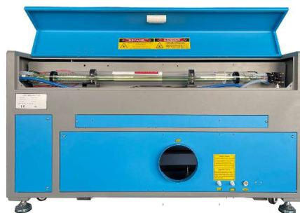
La fluctuation le long de la ligne doit être inférieure à 5 %. En cas de dépassement, les fusibles sautent. Ils sont situés dans la prise de raccordement et sont accessibles de l'extérieur. De même, ne branchez pas cet appareil sur des rallonges ou des multiprises standard. Branchez-le directement sur une prise de terre ou utilisez un parasurtenseur d'une capacité supérieure à 2000J.
