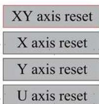
Appuyez sur ▲ ou ▼ pour sélectionner une option. En appuyant sur la touche **ENT**, vous démarrez la mise à zéro de l'axe sélectionné et le message "Resetting Is Underway" s'affiche à l'écran. Une fois terminé, le message disparaît automatiquement et le système revient au menu principal.
