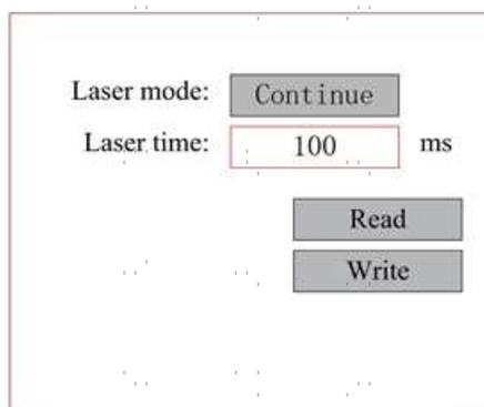
Le fonctionnement est le même que pour le réglage précédent. Lorsque "Continue" est sélectionné, appuyez sur **PULSE** pour tirer le laser et relâchez le bouton pour arrêter le tir. Pour terminer le réglage, sélectionnez **Write** avec la **touche ENT** pour l'enregistrer ou quittez le menu avec la **touche ESC** sans appliquer vos modifications. Les paramètres enregistrés peuvent être chargés via **Read**.
