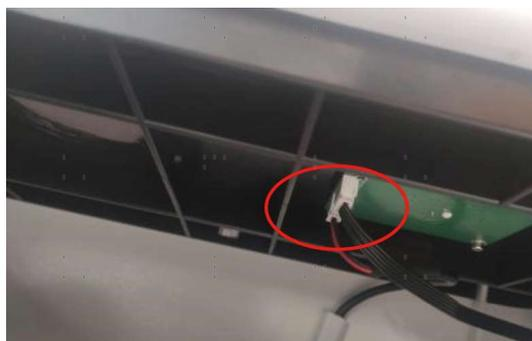
Retirez les vis avant et arrière et enlevez les panneaux. Remettez-les en place en utilisant les mêmes vis, puis rétablissez les connexions électriques.
