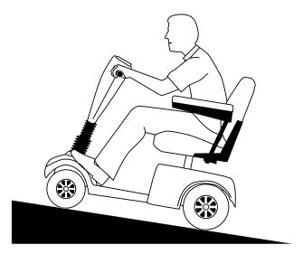
FIGURE 2A. INCREASED STABILITY DRIVING POSITION
