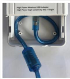
3. Setzen Sie die Abdeckung wieder auf die Unterseite der Antenne und vergewissern Sie sich, dass das Kabel aus einem der Löcher auf der Unterseite herauskommt, so dass das Gerät wasserdicht ist.
