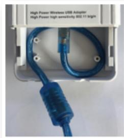
3. Remplacez le couvercle du bas de l'antenne et assurez-vous que le fil sort de l'un de ses trous, de sorte que l'appareil soit étanche à l'eau.
