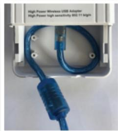
3. Vuelva a colocar la cubierta de la antena WiFi y asegúrese de que el cable sale de uno de los orificios en la parte inferior, para que la unidad quede hermética.
