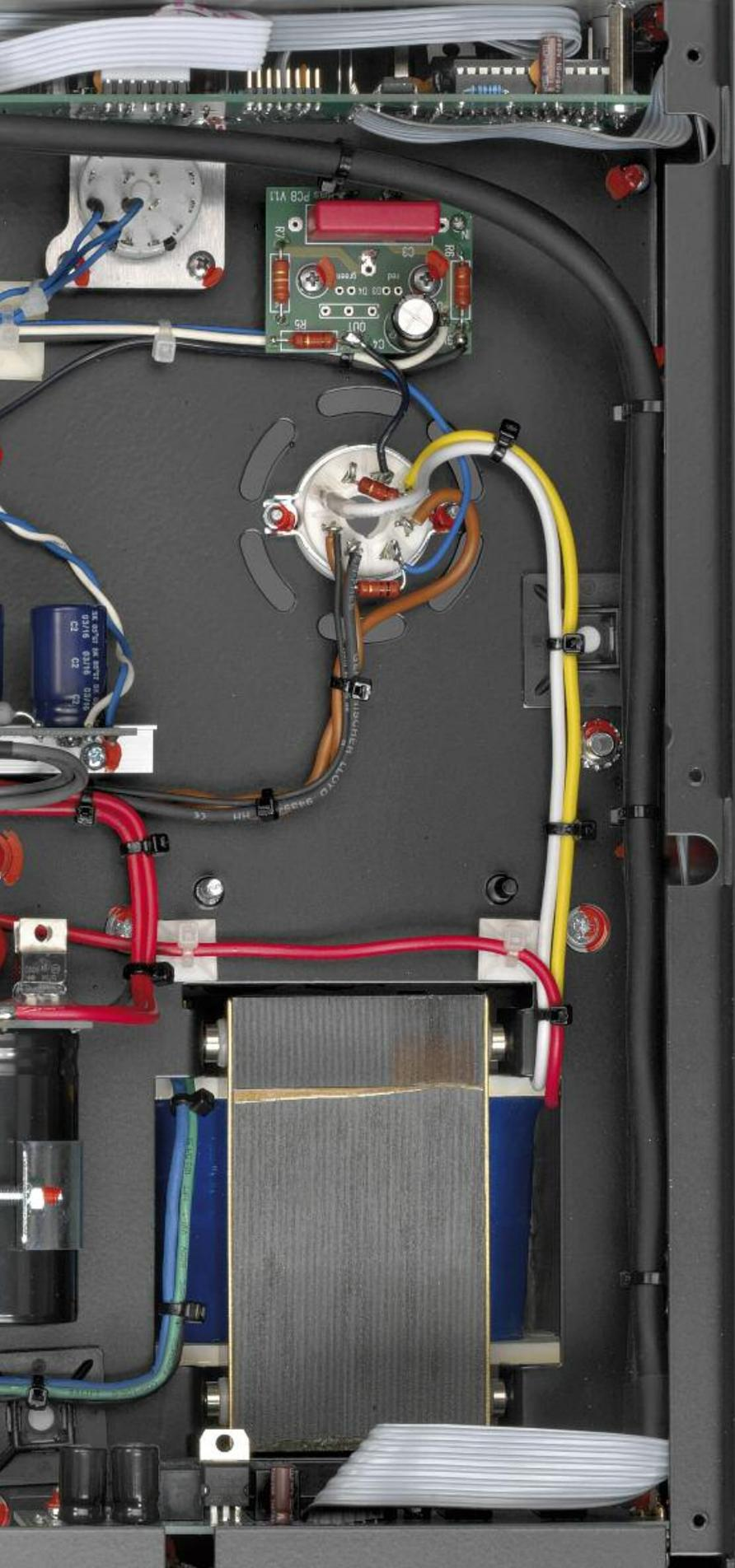
Oben links sitzt die Platine mit dem Potentiometer für die Bias-Einstellung an V1 (linker Kanal), rechts daneben der Umschalter für die Anzeige (VU/OFF/Bias). Rechts oben ist das Lautstärke-Potentiometer mit dem Motor für die Fernbedienung zu sehen. Mit dem Tube-Select-Schalter rechts neben dem Motorpotentiometer wird die linke oder die rechte Endstufenröhre für den Bias-Abgleich angesteuert, daneben rechts befindet sich das Potentiometer zur Bias-Einstellung für V2 (rechter Kanal)
