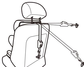
※車両によってテザーアンカーの位置が異なりますので、車両の取扱説明書で確認してください。
