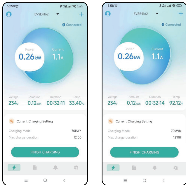
Image 37 Page de commutation rapide du type de température sur la page d'accueil de l'APP
