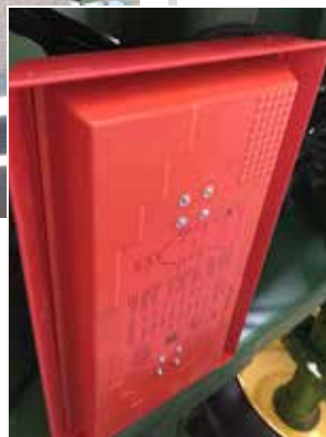
Die Schale wird unter dem Mährescher an den Elektromagneten der Abwurfseinrichtung befestigt. Über die Steckdose am Zugmaul kommt die Stromversorgung. Schaltet man das Standlicht ein, wird der Abwurf ausgelöst.
