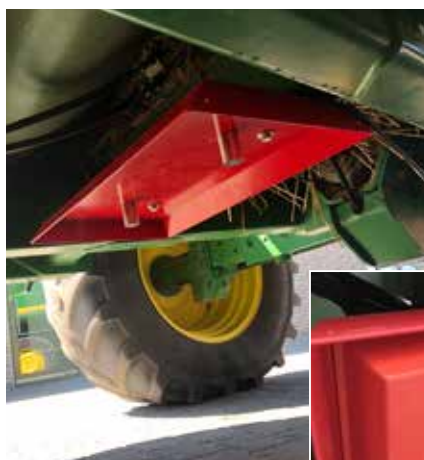
Die Schale wird unter dem Mährescher an den Elektromagneten der Abwurfseinrichtung befestigt. Über die Steckdose am Zugmaul kommt die Stromversorgung. Schaltet man das Standlicht ein, wird der Abwurf ausgelöst.
