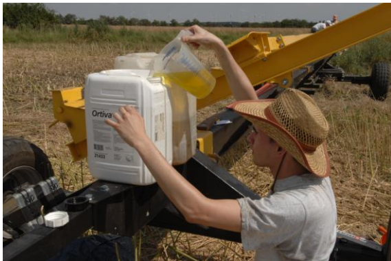
Auslitern des Kraftstoffverbrauchs
