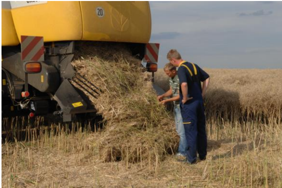
Grüne „Gummischoten“ werden im Dreschwerk nicht geöffnet und gehen als Ausdruschverlust verloren
