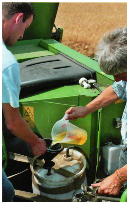
Bild 6: Exaktes Auslitern des Kraftstoffverbrauches mit separatem Tank. Halbzweige verbrauchten 35 % weniger Diesel
