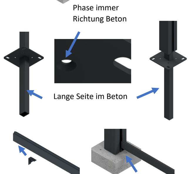
Nach dem Setzen der ersten Leiste kann das erste Anschlussbrett gesetzt werden. Im Anschluss daran wird der Sichtschutz bis oben hin aufgefüllt. Hierbei müssen Sie darauf achten, welche Version Sie haben möchten.
