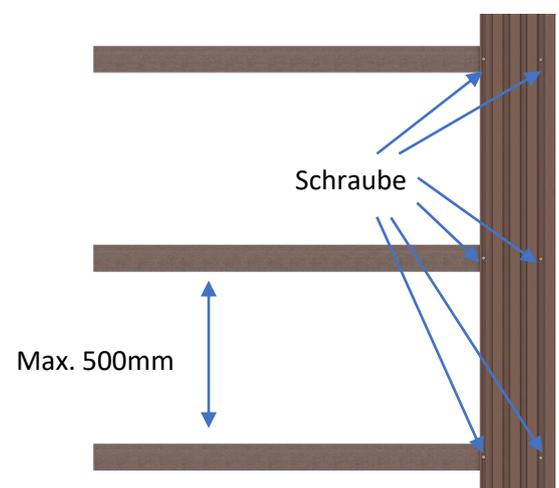
Nach dem Setzen des ersten Profils kann das nächste Profil über das erste geschoben und befestigt werden. Dies wird bis zum Ende durchgeführt. Die Schrauben werden vom nachfolgenden Profil verdeckt. Die Schrauben sind nicht sichtbar. Das letzte Profil muss zugeschnitten und sichtbar verschraubt werden.
