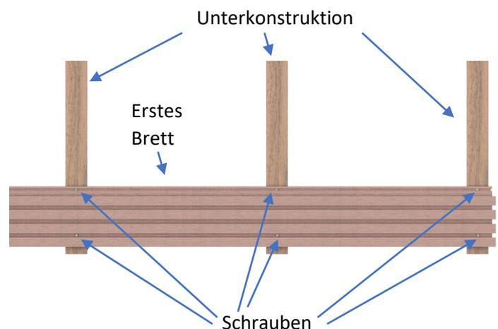
Nach dem Setzen des ersten Profils kann das nächste Profil auf das erste geschoben und befestigt werden. Dieses Vorgehen wird bis zum Ende durchgeführt. Die Schrauben werden vom nachfolgenden Profil verdeckt. Die Schrauben sind nicht sichtbar. Das letzte Profil muss zugeschnitten und sichtbar verschraubt werden.
