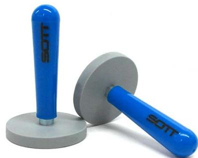
La denuncia comune degli installatori di pellicole è che i magneti di montaggio spesso mancano di quel piccolo extra di forza in più. Questo magnete risolve il problema. La base contiene 6 magneti al neodimio che si combinano con una forza magnetica di oltre 7,5 kg. Di conseguenza sono necessari pochi magneti per mantenere il film, da applicare, in posizione senza che si sposti.
