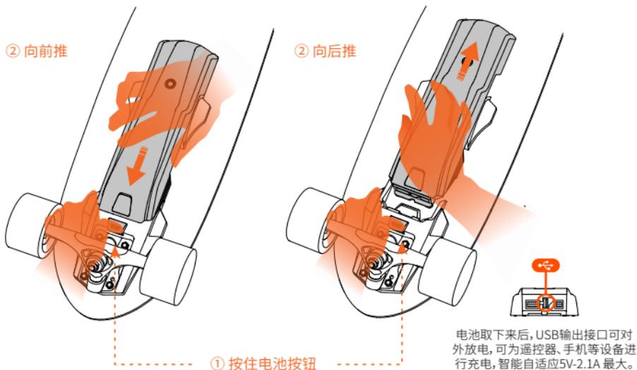
**安装:**将电池直接对接接口后, 向前推入即可装入电池。(装好后请确认电池是否安装到位, 否则使用途中可能掉出造成危险!)
