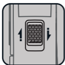
切换方向 拨动方向键 (速度 < 5km/h)
