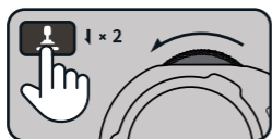
定速巡航 固定油门+短按2次 👤 档位键 (速度 = 5~25km/h)
