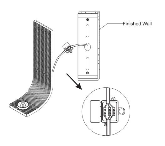
$\underline{\mathsf{STEP}\ 6} \quad \textbf{Mount\ the\ Metal\ Frame}\ : \mathsf{Fix}\ \mathsf{the\ metal\ frame\ groove\ in\ the\ Mounting\ plate\ \mathsf{Properly}.}$
