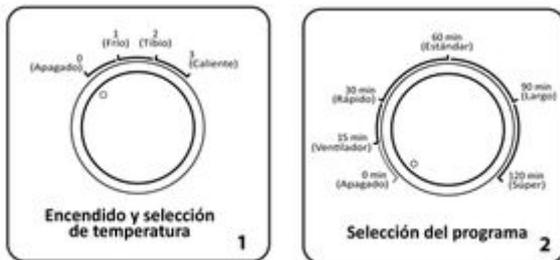
1.-Encendido y selección de temperatura girando la perilla en sentido del reloj, se encenderá el equipo y podrán seleccionar las diferentes temperaturas de trabajo.
