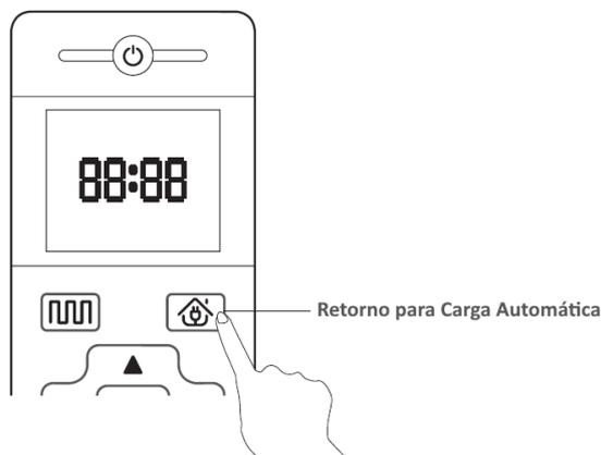
Presionando el botón; “**Retorno para carga Automática**” en el control remoto; el robot regresará para cargar.
