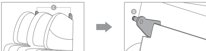
Encaixe as placa de fixação (E), uma em cada lado, para finalizar a instalação.
