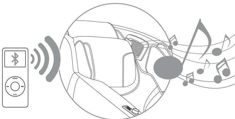
**NOTA:** O sistema de som Bluetooth da poltrona se conecta somente a um dispositivo por vez. Após utilizar, desconecte seu dispositivo para que outro possa se conectar.
