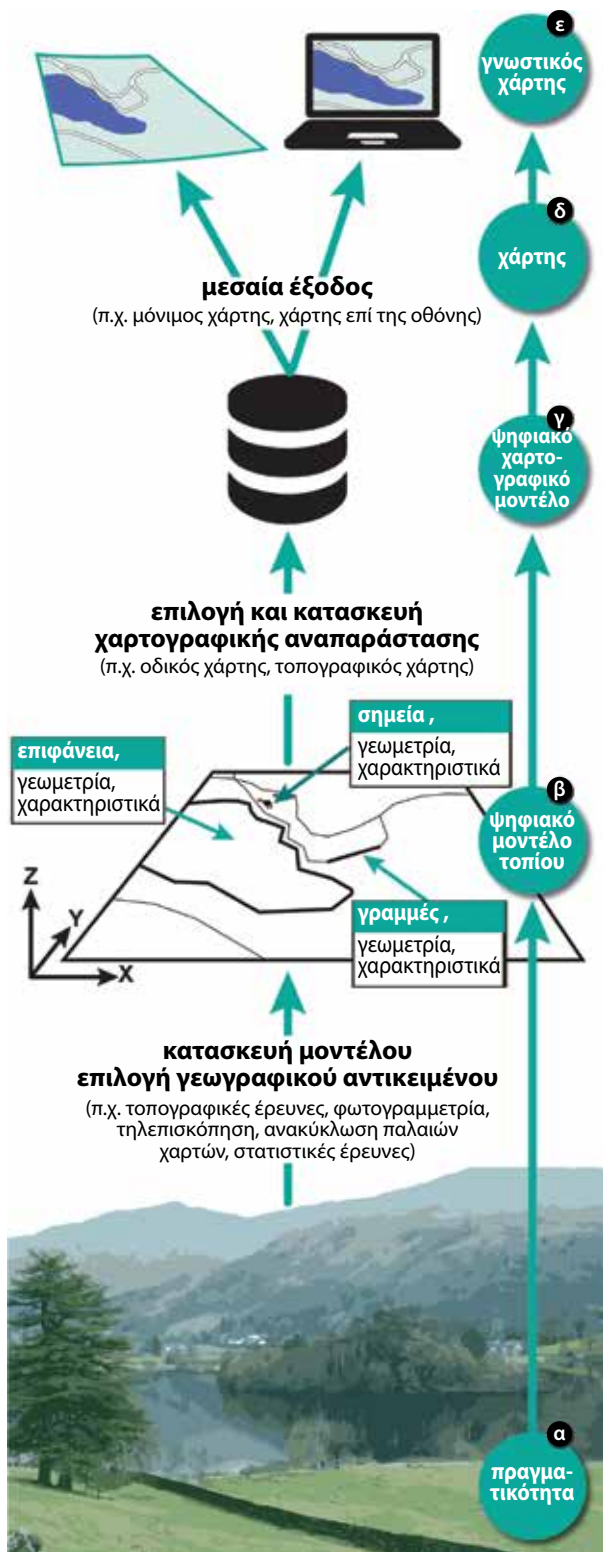
ΕΙΚΟΝΑ 1.4 Η φύση των γεωχωρικών δεδομένων: Από την πραγματικότητα (α), μέσω της κατασκευής και της επιλογής μοντέλων σε ένα ψηφιακό μοντέλο τοπίου (β), που ακολουθείται από την επιλογή και την κατασκευή χαρτογραφικής αναπαράστασης προς ένα ψηφιακό χαρτογραφικό μοντέλο (γ), που παρουσιάζεται ως χάρτης (δ), το οποίο καταλήγει στον γνωστικό χάρτη του χρήστη (ε).
