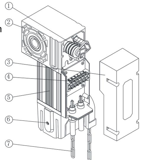
L'operatore è idoneo a porta sezionale industriale dotata di molle di bilanciamento,. L'operatore puo azionare l'albero della porta in presa diretta o tramite trasmissione a catena La configurazione standard è in presa diretta. Se si desidera la trasmissione a catena, utilizzare il kit dedicato.
