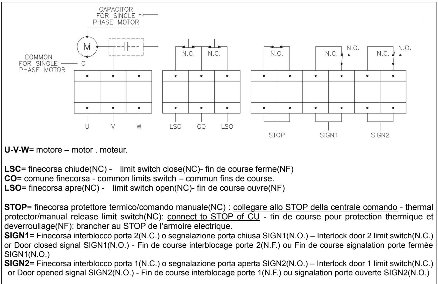
**U-V-W=** motore – motor . moteur.
