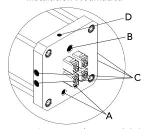
El VTANK tiene 3 puertos auxiliares en cada lado, 2 de ellos 1/4 NPT (A) y uno 3/8 NPT (B), estos puertos pueden usarse para suministro de aire (compresores eléctricos), cilindro de monitoreo de presión interno (manómetro), o cualquier otra necesidad de un punto de fuente de aire.
