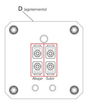
**Recuerde:** Tenga en cuenta que cada lado del VTANK es un bloque independiente de 4 válvulas, lo que significa que cada cubierta lateral del VTANK tiene un par de válvulas para subir y un par de válvulas para bajar las bolsas.
