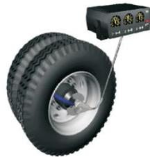
Una de las estrategias es la adopción del **sistema de inflado automático de llantas** para tractocamiones y remolques, esta tecnología ha incrementado hasta un 75% el rendimiento de las llantas en la flota de distribución.
