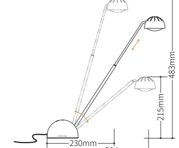
③ヘッドの角度調整: アームを押さえながらヘッドを上下に動かすことで角度を調節できます。
