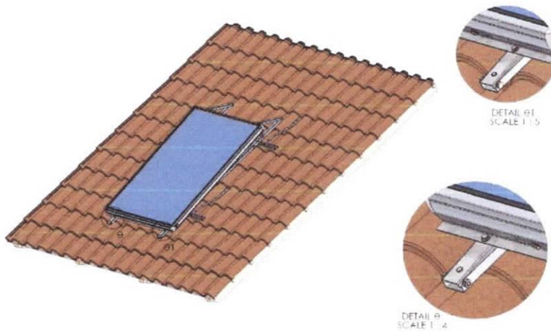
Siempre de acuerdo con la **imagen (H)** y coloque el/los colector/es y el acumulador. Desembale el/los colector/es y súbelo/s al soporte. Este/os se encaja(n) en la traviesa apoyo colectores **GS1 / GS2**. En el caso de sistemas de dos colectores primero hay que unir los colectores entre sí, utilizando los racores de compresión de cobre suministrados  $\varnothing 22 \times \varnothing 22$  (No 17).
