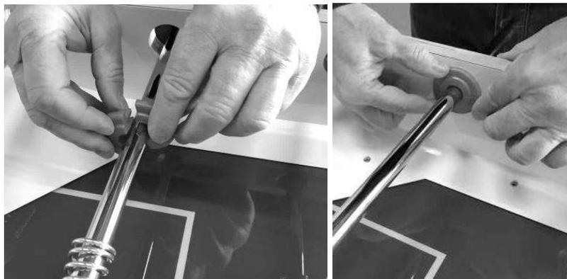
Inserire le aste all'interno degli appositi fori del cassone e montare le boccole. Lasciare il foro nella parte inferiore e fissare con la vite mm 4x25.
