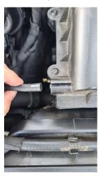
2. Nun lösen Sie die 8 (T27) Schrauben vom Deckel des Luftfilters.
