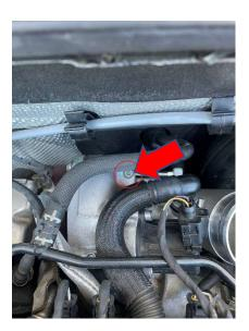
37. Als nächstes muss mit einem 3er Imbus die Aufnahme der Schraube am Turboinlet fixiert werden.
