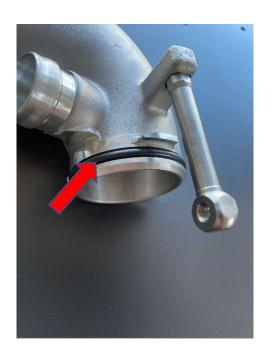
35. Nun muss das Turboinlet in den Turbolader gesteckt und wieder gegen den Uhrzeigersinn reingedreht werden.
