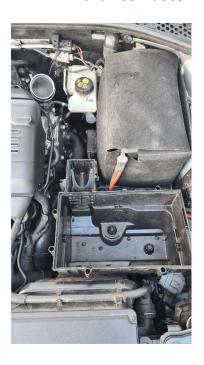
6. Bei den angegebenen Befestigungspunkten müssen nun die Gummihalter mit Schmieröl eingesprüht werden.
