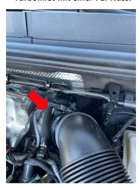
18. Lösen Sie nun den Stutzen vom Ansaugschlauch.
