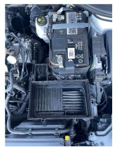
22. Bei den angegebenen Befestigungspunkten müssen nun die Gummihalter mit Schmieröl eingesprüht werden.
