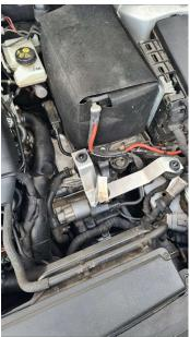
10. Nun stecken Sie den Luftfilter und den Silikonschlauch bis zum Ende der geraden Fläche auf das Carbonrohr. Wichtig: Wenn der Filter zu wenig oder zu weit auf dem Carbonrohr steckt, kann der Filter im Betrieb abrutschen!
