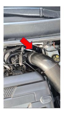
4. Jetzt nehmen Sie den Deckel samt Ansaugschlauch ab.
