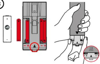
ロックが外れたらバッテリーユニットを引き出す。付属のアルカリ単4電池6本を(+)(-)マークに注意しながら装着する。本体上部側面の▼マークとバッテリーユニット▲マークを合わせて戻し入れる。バッテリーユニットを片手で押し込んで固定しながらバッテリーロッククリップを外側に動かし、バッテリーユニットを固定する。
