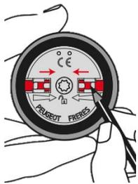
外した本体上部の底にあるバッテリークリップ2箇所を図のように先のとがったペンなどで内側に動かす。
