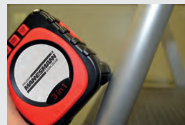
Messung durch abrollen der Strecke
