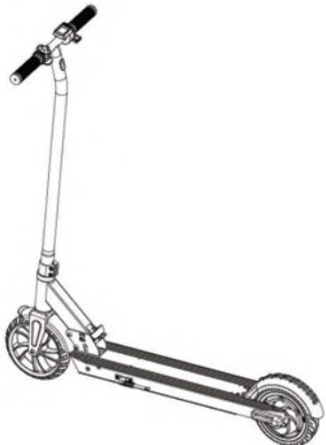
5. Handgriff installieren, schrauben Sie den linken und rechten Lenker in Schraubenlöcher ein.
