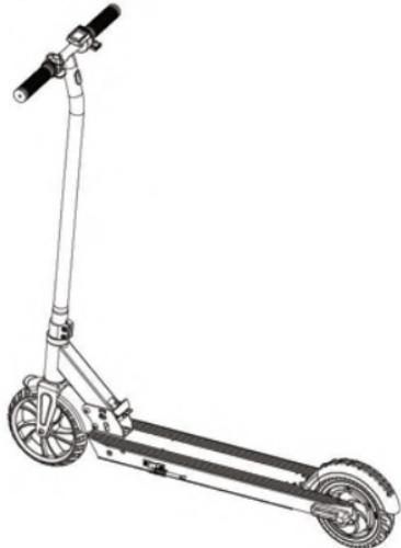
5. Montaje de los mangos, atornille los agarres izquierdo y derecho en los orificios de los tornillos.
