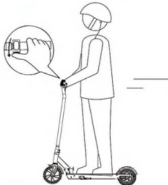
4.Durch das Drücken der Beschleunigungstaste am rechten Griff kann sich das Radfahr langsam fahren lassen, und drehen Sie den Griff, um die Fahrtrichtung zu steuern (ähnlich wie beim Fahrrad).
