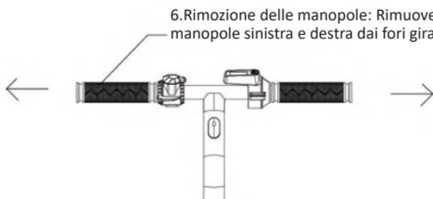
6.Rimozione delle manopole: Rimuovere le manopole sinistra e destra dai fori girandole.
