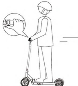
5.Premere leggermente il tasto di accelerazione alla manopola destra per accelerare il monopattino. Non guidare a velocità troppo elevata.
