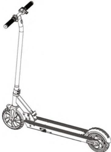
5. Installazione delle manopole: Installare le manopole sinistra e destra negli appositi fori.
