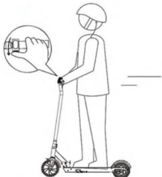
4.Premere leggermente il tasto di accelerazione accanto alla manopola destra per guidare lentamente e girare il manubrio per controllare il senso di marcia (simile a una bicicletta).
