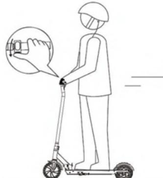
5. Presione suavemente el botón de acelerador de la mano derecha, la patineta puede acelerar la velocidad, recuerde que la velocidad no debe ser demasiado rápida.
