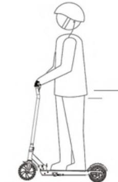
3.Cuando la patineta electrónica marcha, coloque el otro pie en el pedal y mantenga ambos pies estables.
