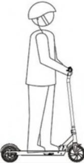
⚠ La conduite en surpoids est strictement interdite (la capacité de poids maximale des scooters électriques est de 150 kg).
