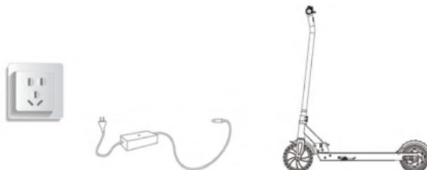
1. En estado de apagado, inserte el enchufe del cargador en el puerto de carga de la patineta electrónica.
