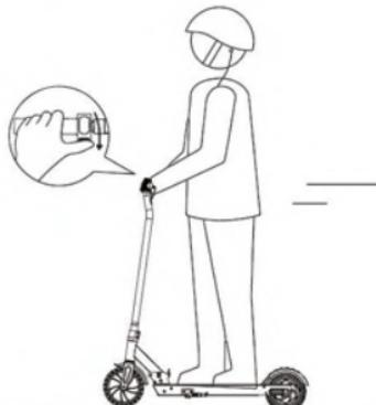
6. Presione el botón izquierdo para frenar, al ser demasiada rápida la velocidad, puede pisar el guardabarros de la rueda trasera por el pie izquierdo como asistente de freno. No presione al fondo el botón de freno, de lo contrario, provocará un freno rápido.
