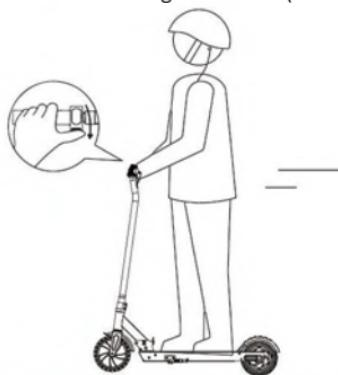
6.Drücken Sie zum Bremsen den linken Griffknopf. Wenn die Geschwindigkeit zu hoch ist, kann der linke Fuß auf den Hinterradkotflügel treten, um die Bremse zu unterstützen. Achten Sie darauf, den Bremsknopf nicht zu fest zu drücken, da sonst eine plötzliche Bremse entsteht.
