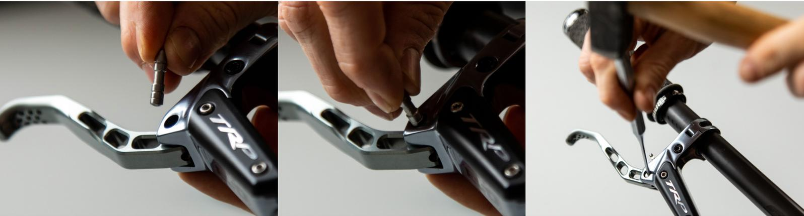
Stecken Sie das Verstellrad nun wieder auf das Gewinde der Hebelweitenverstellung auf und ziehen Sie die Madenschraube handfest an. Richten Sie dabei das Verstellrad so aus, dass die Madenschraube die plane Fläche an der Hebelweitenverstellung klemmt.
