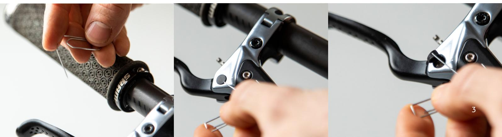
Schlagen Sie nun den Stift mit einem Durchschlag und einem Hammer vollständig nach unten aus dem Bremsgeber. Achten Sie auf die korrekte Montagerichtung beim Wiedereindrücken des Stiftes.
