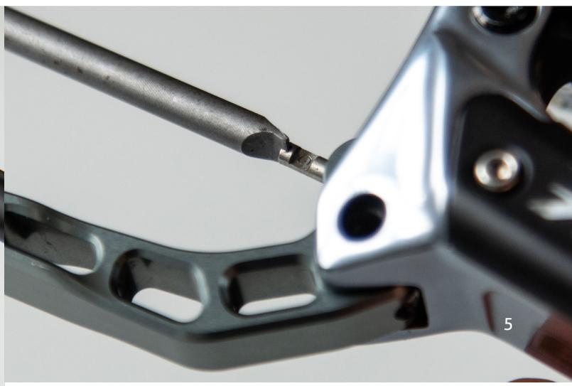
Drücken Sie den Stift von oben wieder in das Gebergehäuse und den TRL Brakelever ein. Beachten Sie dabei die Montagerichtung des Stifts, dieser muss mit dem Ende mit zwei Einkerbungen zuerst eingedrückt werden.
