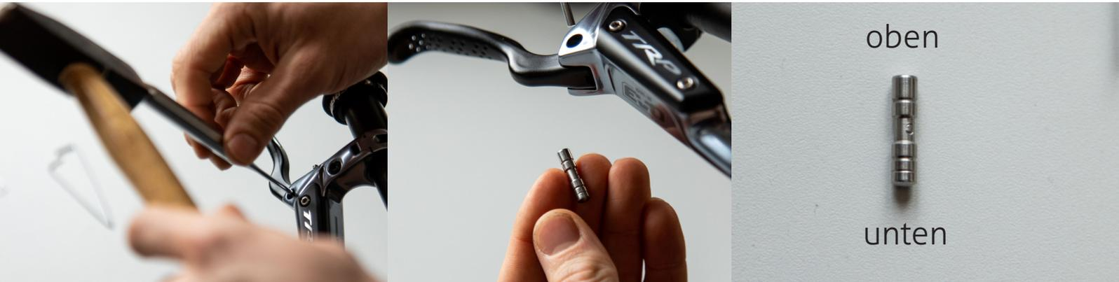
Schrauben Sie die Druckstange der Hebelweitenverstellung mit dem Schraubendreher aus dem Quermutterbolzen aus.
