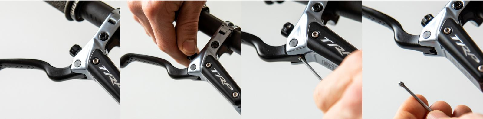
Lockern Sie nun die Madenschraube am Verstellrad der Bremssysteme und ziehen Sie dieses ab.
