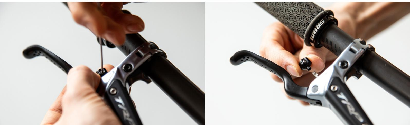
Entfernen Sie die Gummiabdeckung indem Sie mit einem spitzen Gegenstand, wie zum Beispiel einer Büroklammer zwischen Gummiabdeckung und Bremsgebergehäuse fahren und die Gummiabdeckung vorsichtig heraushebeln. Legen Sie die Gummiabdeckung beiseite.
