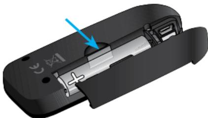
2. Fassen Sie die alte Batterie zwischen Daumen und Zeigefinger und nehmen Sie die Batterie heraus.
