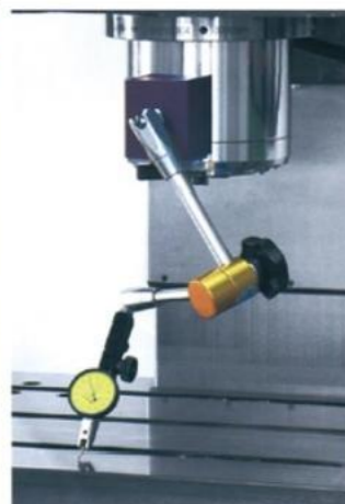
工作台平面精度检测 Table surface precision testing
