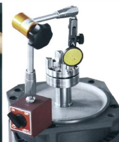
主轴联轴器精度检测 Spindle coupling precision testing
