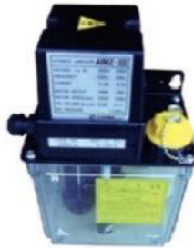
润滑系统 Lubricating system
