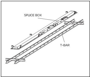
4. REST THE LUMINAIRE ON THE T-BAR OF THE CEILING SUSPENSION SYSTEM IN THE DESIRED LOCATION.
