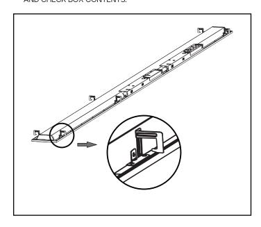
3. LOCATE ALL FOUR EARTQUAKE CLIPS ON THE BACK OF LUMINAIRE. TWIST EACH TAB AWAY FROM LUMINAIRE TEST-ING THEM ON THE T-BAR.
